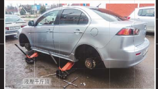
B 汽車維修時常使用液壓千斤頂，以抬起車身。
